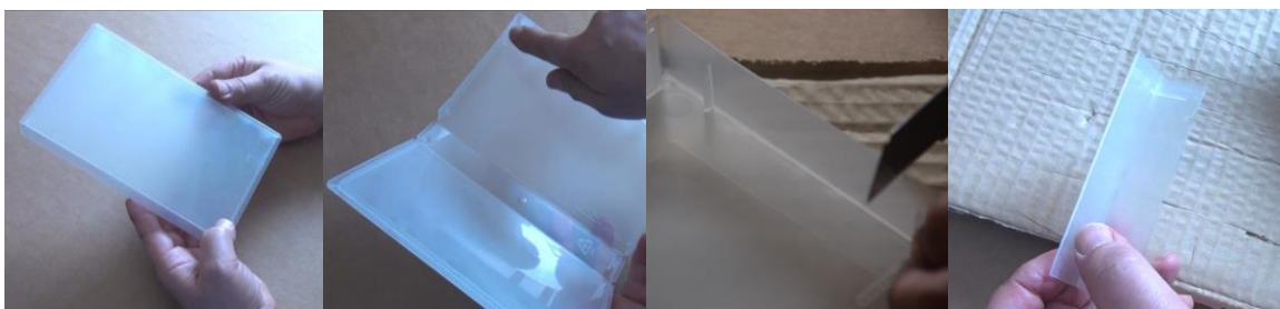
Ilustração 9 – Construção de um rebordo rígido
