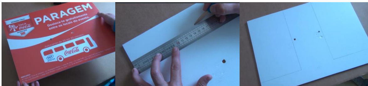
Ilustração 2 - Marcação das medidas na placa de polipropileno
